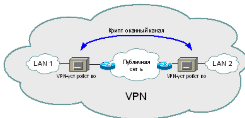
Рисунок 7 – VPN на базе аппаратных средств
