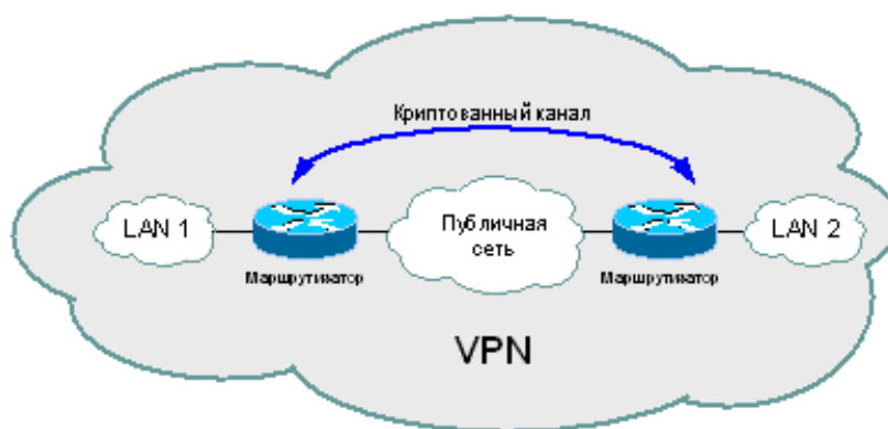
Рисунок 5 – VPN на базе маршрутизаторов
